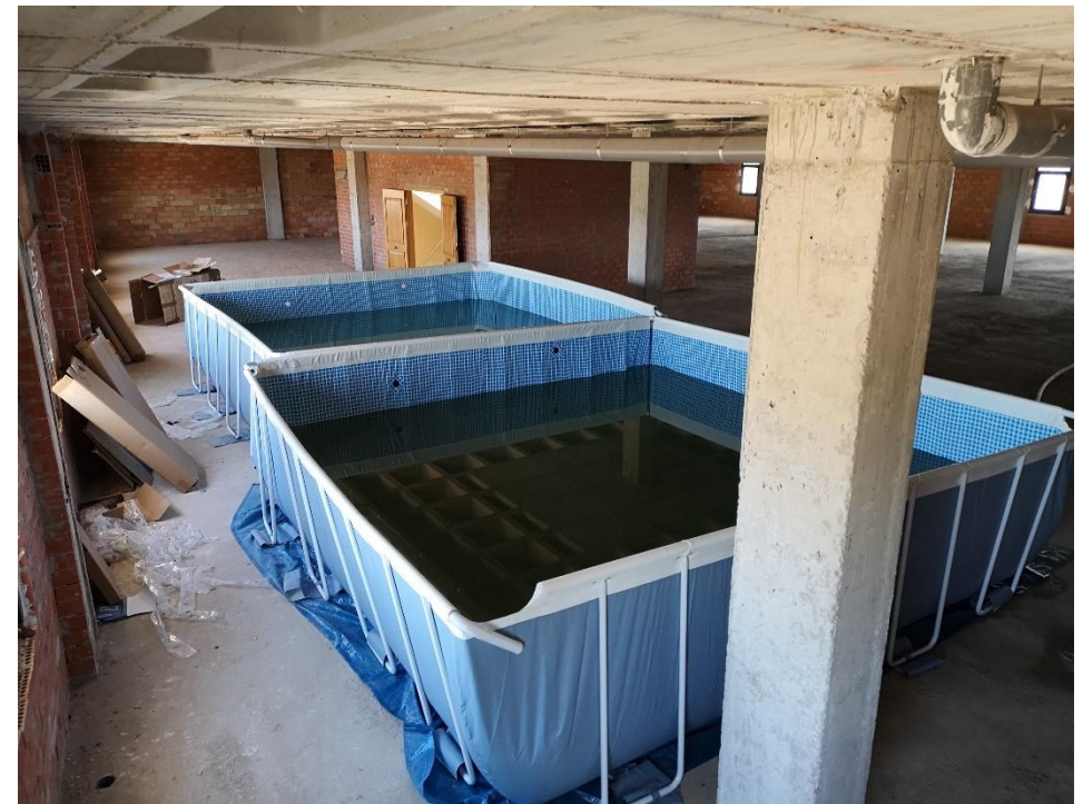
Prueba de carga para instalación de equipos en planta 3ª del edificio de EGUSA ubicado en la calle dels Calderers, n°86-88 (Alboraya) [Valencia].
