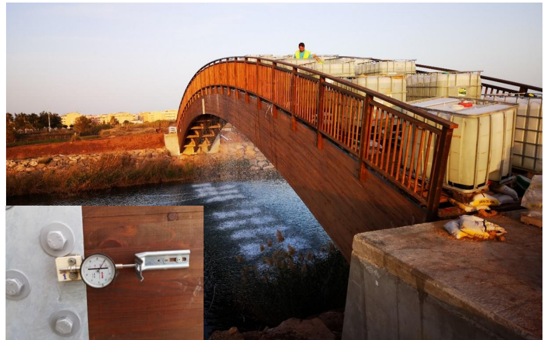
Prueba de carga de pasarela peatonal de madera en la desembocadura del Río Belcaire en el término municipal de Moncófar (Castellón).
